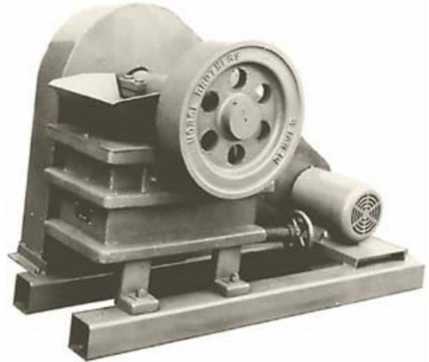
Щека и щековые пластины изготовлены из износостойкой легированной стали, прошедшей термообработку. Бронзовые сверхмощные вкладыши подшипника могут быть легко заменены. Чугунная станина, защитный кожух мотора и питающий бункер смонтированы на трубчатой стальной раме.
